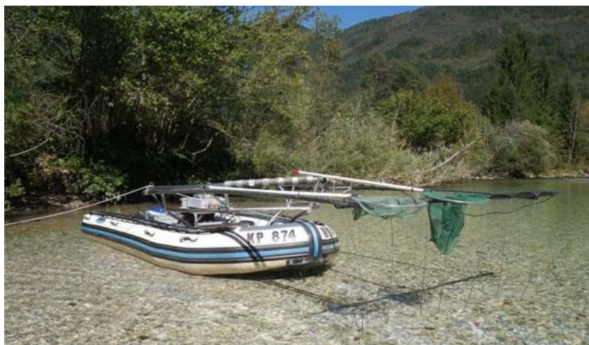
Slika 2: Vzorčevalni čoln opremljen za kvantitativni izlov.
