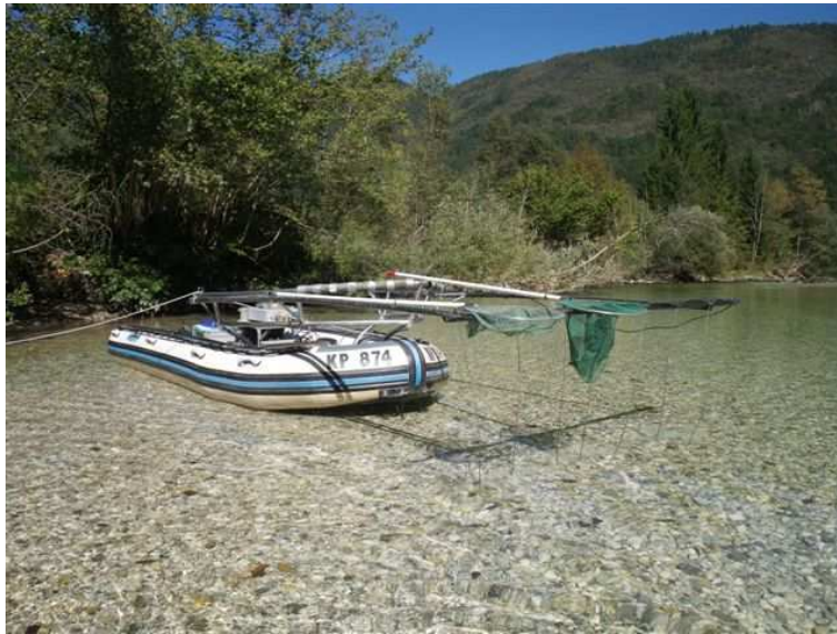
Slika 4: Vzorčevalni čoln opremljen za kvantitativni izlov.
