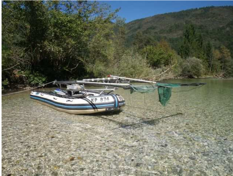
Slika 4: Vzorčevalni čoln opremljen za kvantitativni izlov.
