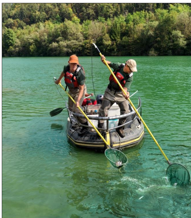
Slika 1: Vzorčenje z elektroribolovom s čolna (foto: ZZRS).
