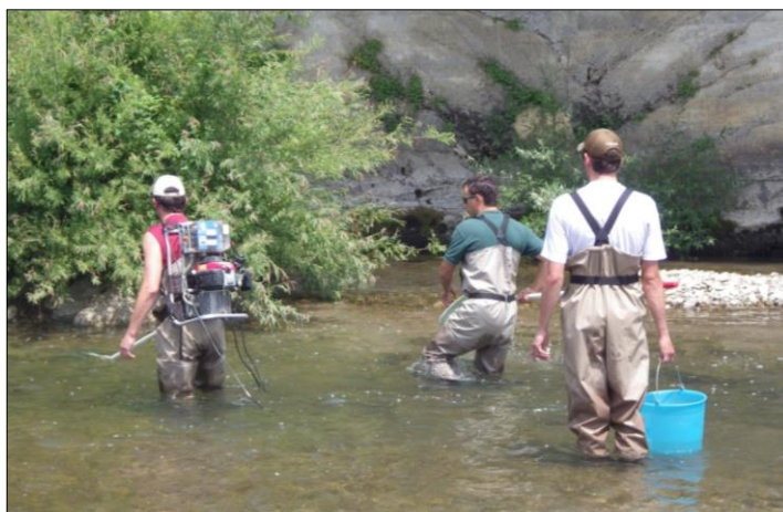
Slika 1: Izvajanje elektroribolova z brodenjem.
