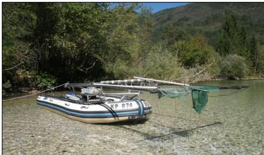
Slika 2: Čoln z opremo za kvantitativni elektroribolov. Anode so stacionarne in nameščene na premcu čolna.
