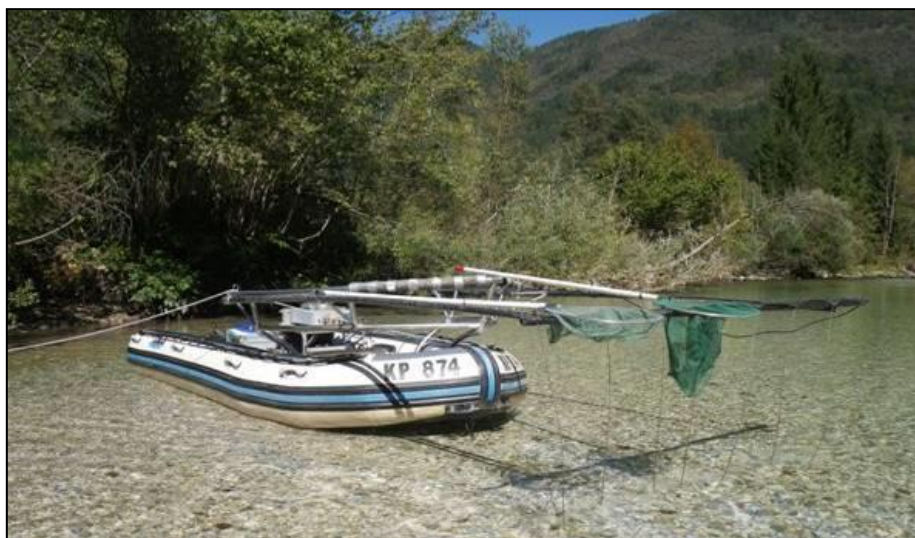
Slika 4: Čoln z opremo za kvantitativni elektroribolov. Anode so stacionarne in nameščene na premcu čolna.
