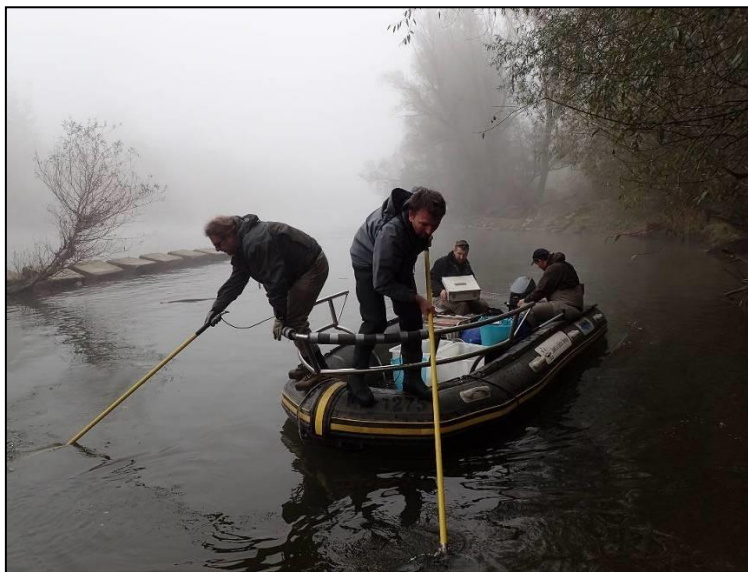
Slika 1: Vzorčenje s semikvantitativnim elektroribolovom s čolna.
