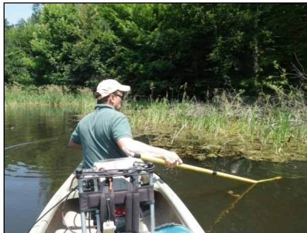
Slika 2: Vzorčenje činklje s kanujem v globjih predelih vodnih teles.
