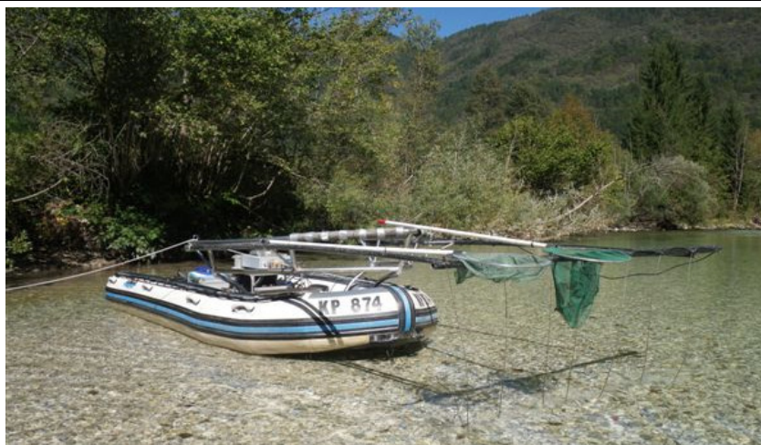
Slika 2: Čoln z opremo za kvantitativni elektroribolov.
