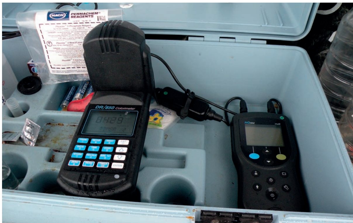
Slika 7. Merilna instrumenta HACH LANGE HQ40D in HACH LANGE DR850 za merjenje fizikalno kemijskih parametrov v vodi (Foto: R. Slapnik).
