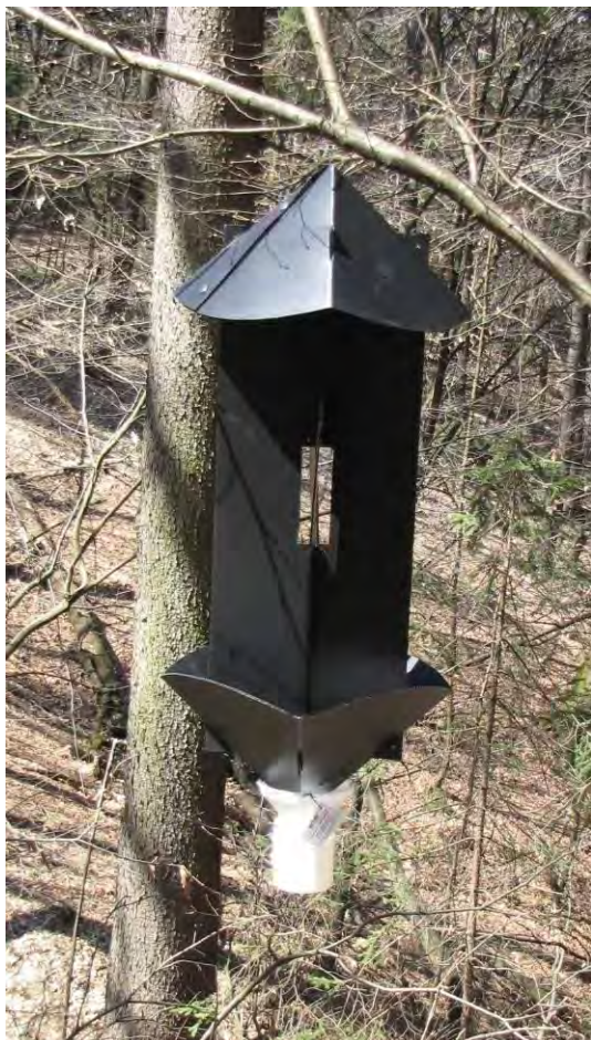
Slika 57: Primer viseče prestrezne pasti, ki smo jo uporabili kot feromonsko past za puščavnika ( Osmoderma eremita ). (foto: Andrej Kapla)
