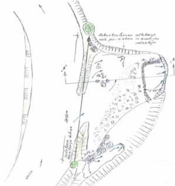
Slika 5: Sanacija prelivnega polja Milavčevi ključu številka 33 (risba: I. Lampič)
